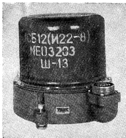
Рис. 1.38. Внешний вид гироскопического интегратора продольных ускорений ИСБ12
