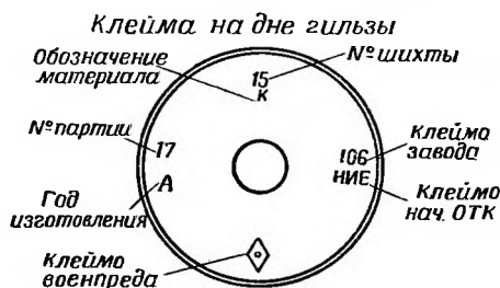
Клейма на дне капсюльной втулки КВ-5
