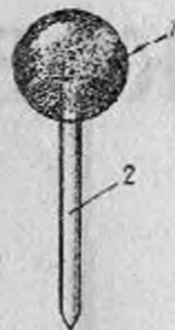
1 — пуля; 2 — стабилизатор в виде гвоздя.
