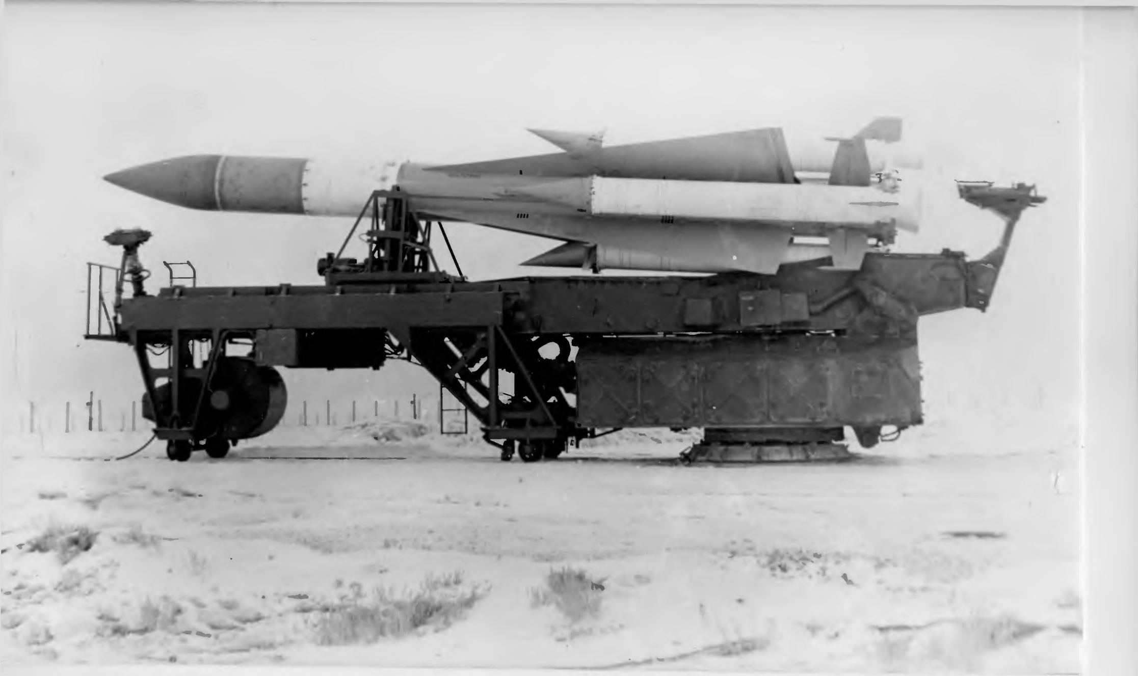
Перегрузка ракеты В-880 с заряжающей машины 5Ю24Р на пусковую установку 5П72ВР.
