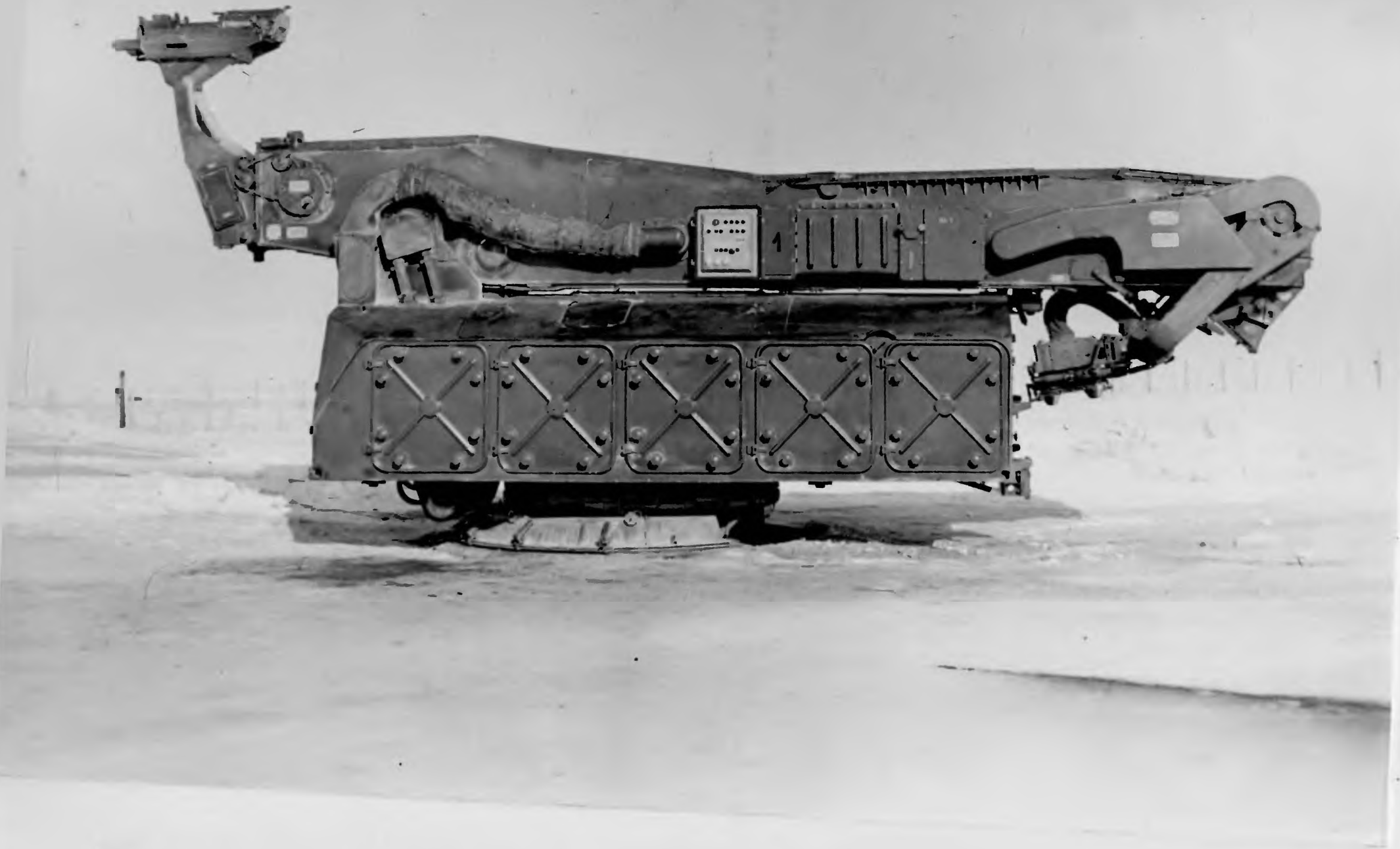
Пусковая установка 5П72ВР с открытой крышкой (1) на блоке обогрева (БО-200 Q).
