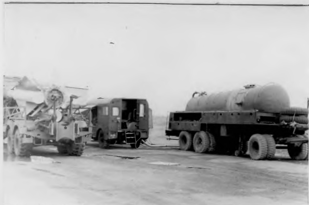
Заправка ракеты В-880 окислителем при помощи заправщика 5Л62А.
