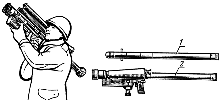
Рис. 39. Переносный зенитный ракетный комплекс: 1 — ЗУР; 2 — пусковая установка (труба)
