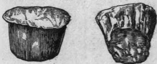
Рис. 134. Пробки, выбиваемые бронейными снарядами из броневой плиты
