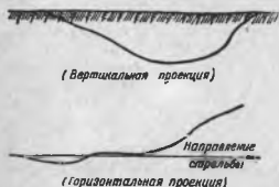
Рис. 349. Проекция пути снаряда в грунте
