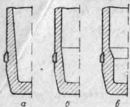
Рис. 196. Различные способы упрочнения корпуса снаряда в нижней части
