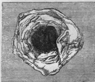
Рис. 135. Пробойна в броневой плите высокой твердости
