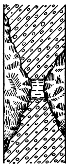
Рис. 39. Пробоина в бетонной стенке
