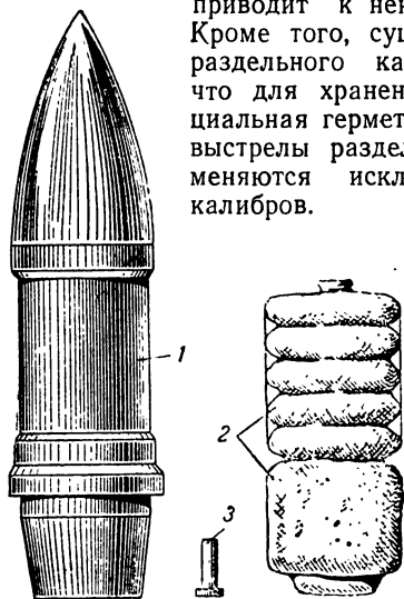
Рис. 3. Выстрел раздельного картузного заряжания:
