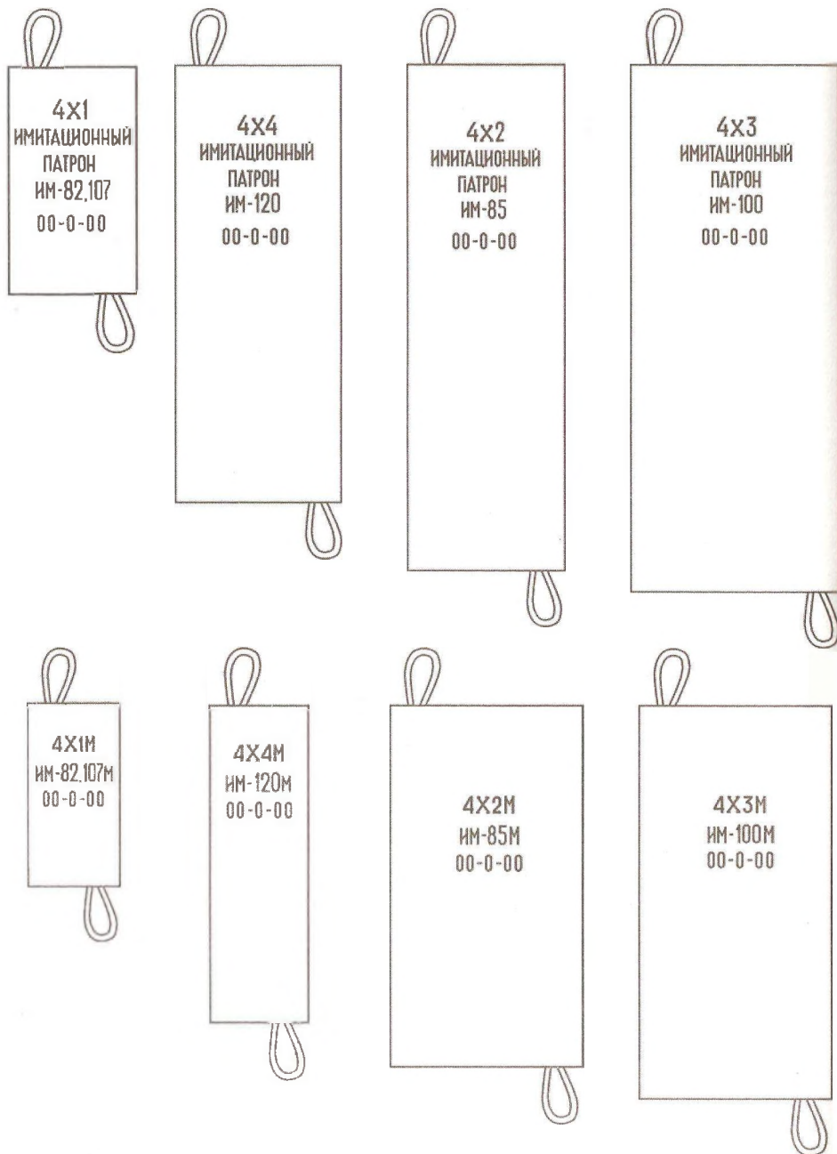
4.23. ИМИТАЦИОННЫЕ ПАТРОНЫ (сравнительные размеры)
