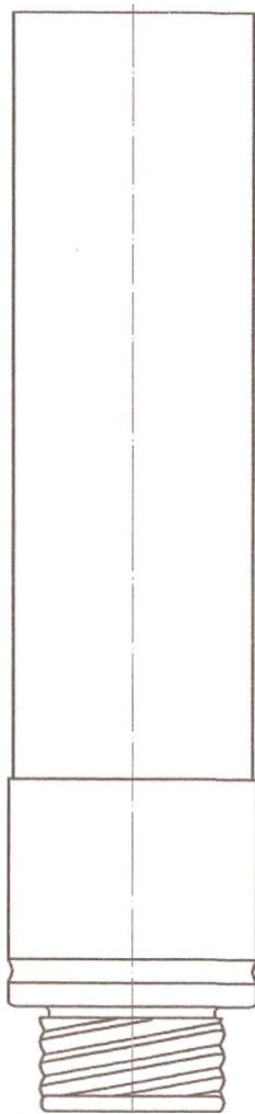
40-мм реактивный осветительный патрон, длина цоколя 54 мм
