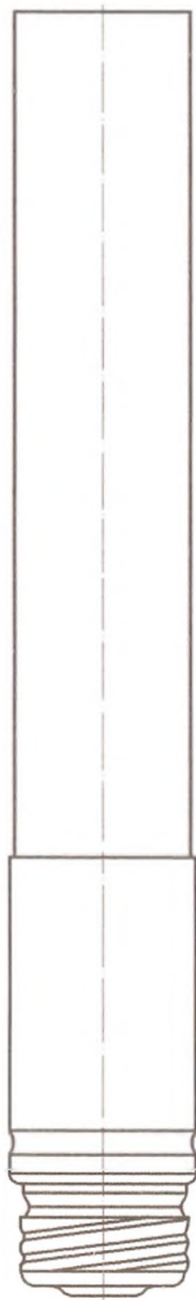
30-мм реактивный осветительный патрон, длина цоколя 79 мм
