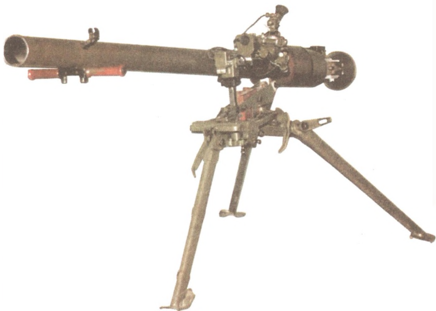
82-мм станковый гранатомёт СГ-82, выстрел ПГ-82
