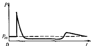
Рис. 3.25. Зависимость давления от времени в фиксированной точке при взрыве заряда в воде
