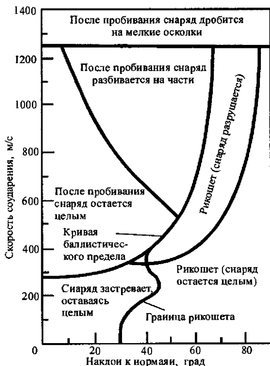
Рис. 4.9. Фазовая диаграмма, характеризующая соударение ударника с мишенью
