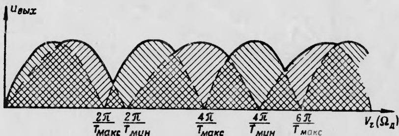
Рис. 61. Амплитудно-скоростная характеристика системы СДЦ при переменном периоде повторения
