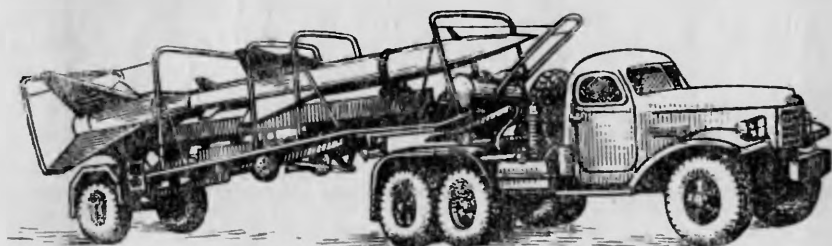
Рис. 123. Транспортно-заряжающая машина (без маскировочного чехла)
