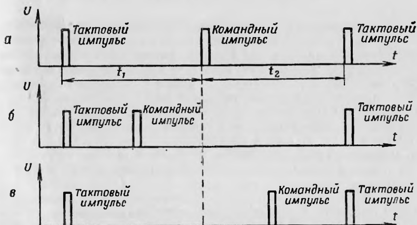
Рис. 66. Принцип балансной временной импульсной модуляции
