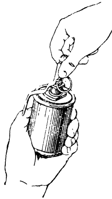
Рис. 11. Вставление и завинчивание в гранату запала
