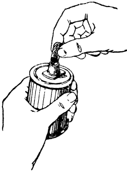
Рис. 10. Вытнимание деревянной пробки из гнезда фланца гранаты или снятие металлического колпачка
