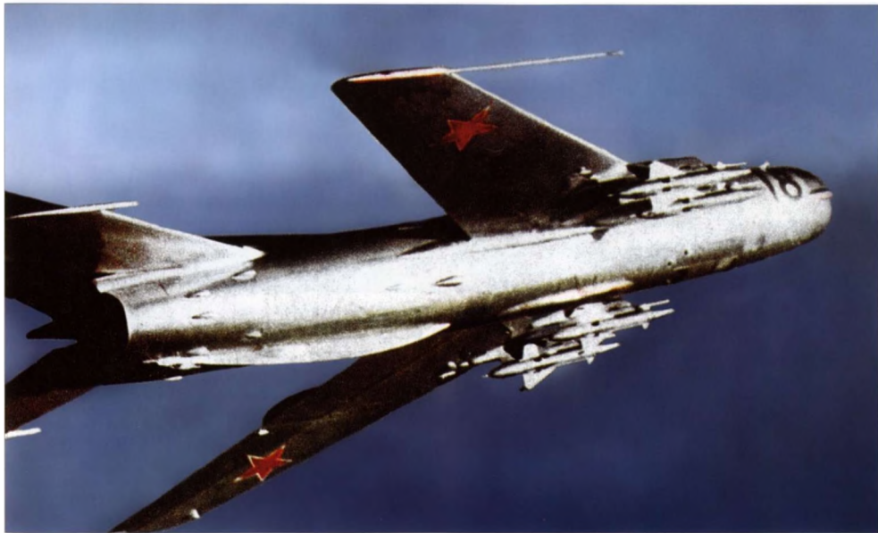
Истребитель-перехватчик МиГ-19ПМ с ракетами РС-2У MiG-19PM fighter-interceptor equipped with RS-2U missiles
