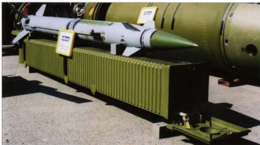
5. Ракета 9М33М3 и транспортно-пусковой контейнер 9M33M3 missile & transporting-launching container
