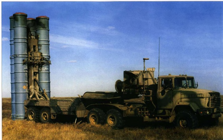
Пусковая установка ЗРС С-300ПМУ с ракетами 4ВН6 5-300PMU AD missile system launcher with 4ВН6 missiles
