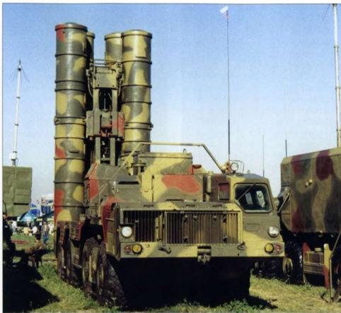
Пусковая установка ЗРС С-300РМУ-2 с ракетами 48Н6Е2 S-300PMU-2 AD missile system launcher with 48N6E2 missiles
