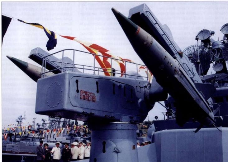
Ракеты 4К60 на пусковой установке 4K60 missiles on the launcher
