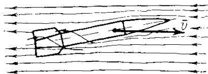
Фиг. 6. 21. Развитие зоны пониженного давления за срезом сопла ракеты, летящей с неработающим двигателем.
