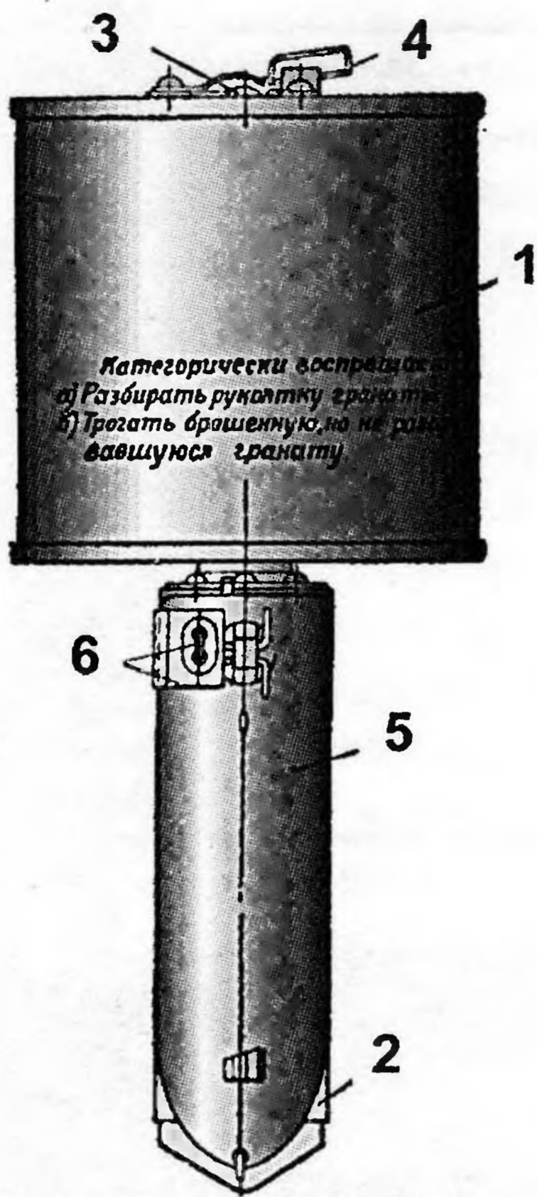
Ручная противотанковая граната ударного действия РПГ-40: 1 – корпус гранаты; 2 – рукоятка ударного действия; 3 – запал; 4 – задвижка запала; 5 – предохранительная планка; 6 – предохранительный шплинт с флажком
