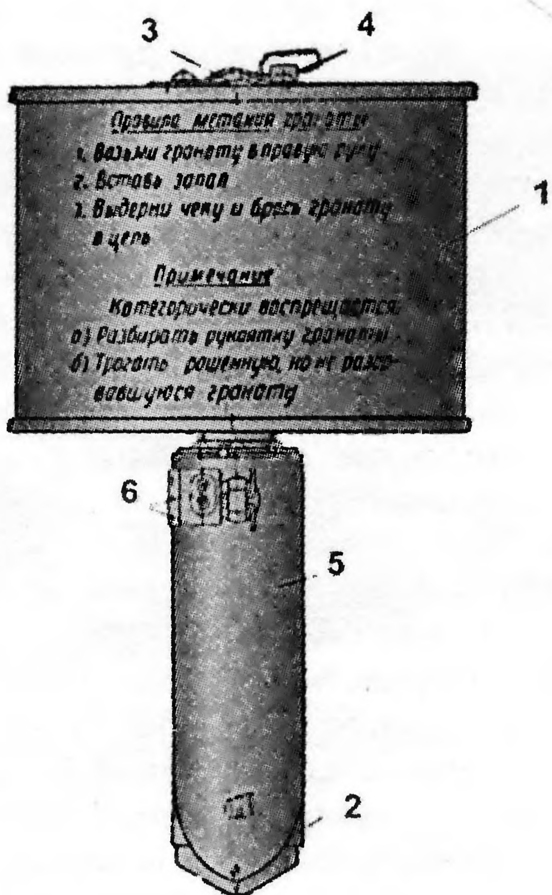
Ручная противотанковая граната обр. 1941 г. РПГ-41: 1 – корпус гранаты; 2 – рукоятка ударного действия; 3 – запал; 4 – задвижка запала; 5 – предохранительная планка; 6 – предохранительный шплинт с флажком
