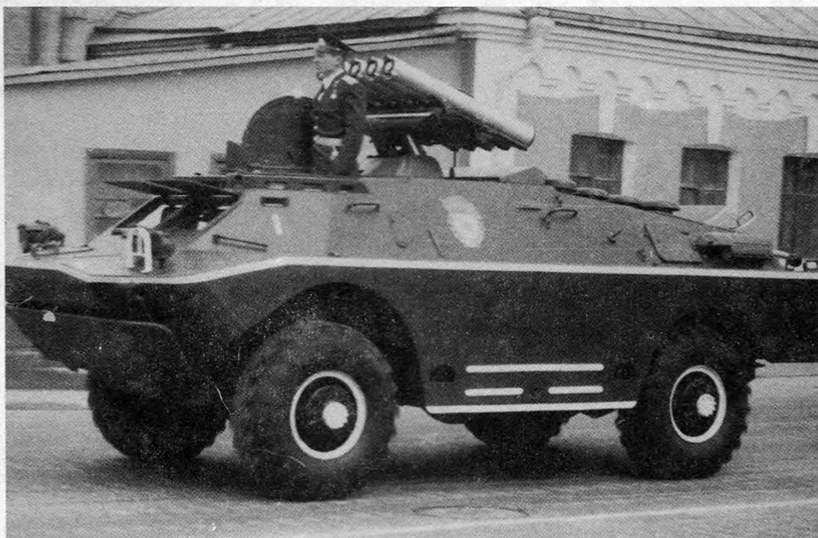
ПУ 9П148 на базе БРДМ-2 в боевом и походном (справа внизу) положении
