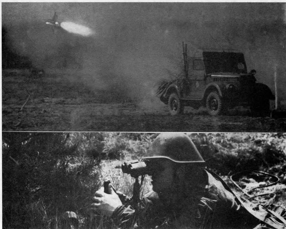
Пуск ПТУР «Шмель» комплекса 2К15. Обратите внимание, что в качестве прибора наблюдения используется полевой бинокль
