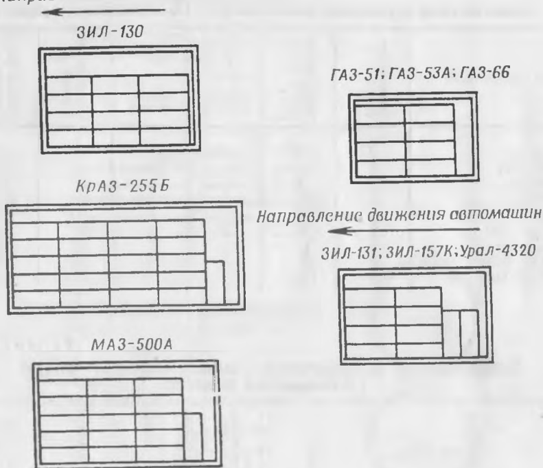
Рис. 52. Схема укладки ящиков со снарядами 9М111М в кузовах автомашин
