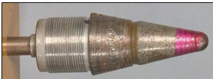
A-670M (ударний, піротехнічна затримка)
