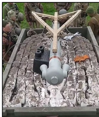
Серії «M58 MICLIC» (протимінні комплекси) Примітка: Використовується з ракетою «МК 22 Mod 4». Країна походження: США
