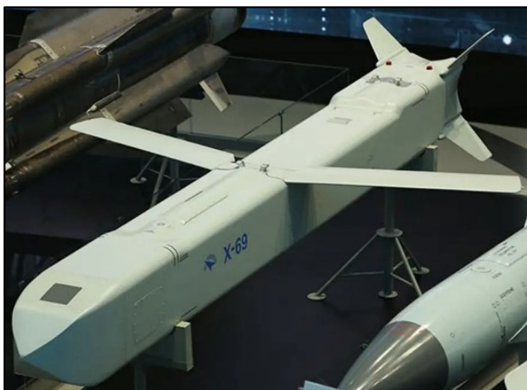
X-69 (бронебійно-фугасна або касетна, осколково-фугасні суббоєприпаси)
