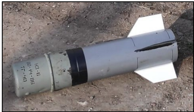
Кумулятивний заряд КЗ-6 адаптований до скидання з дрона (кумулятивний)
