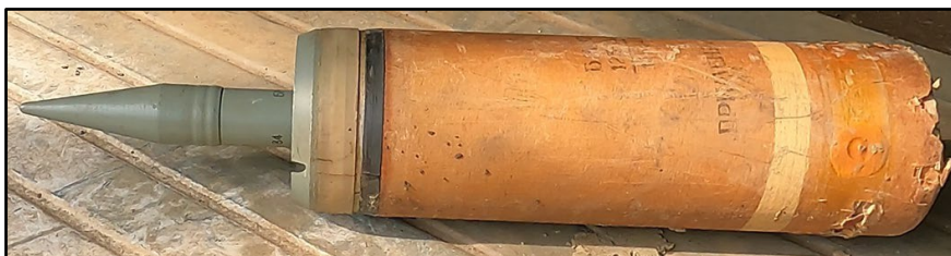
125 мм БМ26-1 (гільза БМ27-1) (бронебійно-підкаліберний оперений снаряд з відкидним піддоном)
