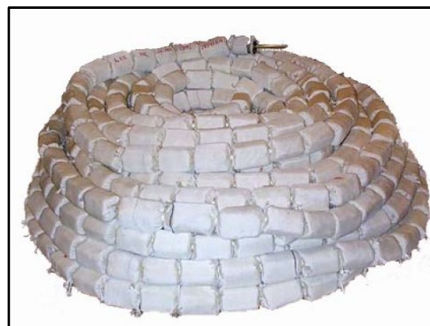
Серії «M58 MICLIC» (протимінні комплекси) Примітка: Використовується з ракетою «МК 22 Mod 4». Країна походження: США
