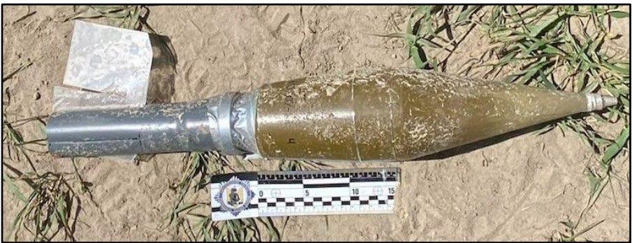
Кумулятивний заряд КЗ-6 адаптований до скидання з дрона (кумулятивний)
