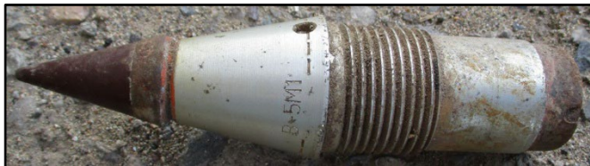
В-5М1 (ударний, піротехнічна затримка)
