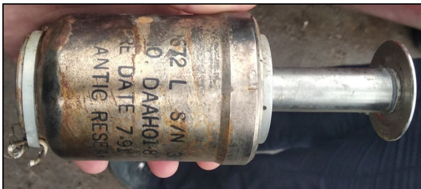
Стартовий двигун для 9K111 «Фагот» (за стандартом НАТО: AT-4A «Spigot»)
