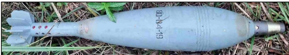
120 мм ОФ36 (осколково-фугасна) Довжина з підризником М-12: 733.5 мм Країна походження: РФ
