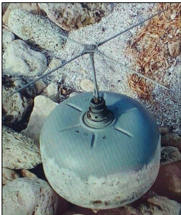
ЯРМ (фугасна) Діаметр: 275 мм
