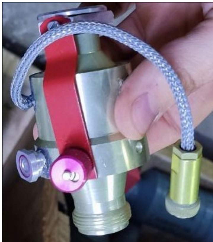
УЗ-2 (ударний, радіокерування)
