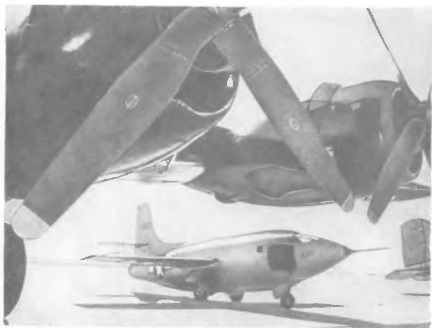
Ракетный самолет X-1 под крылом самолета B-29 (база ВВС Мюрок)
