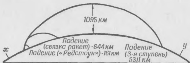
Рис. 55. Траектория полета ракеты «Юпитер»-С. Линии, обозначенные x и y , указывают радиусы Земли, образующие геоцентрический угол в 60^\circ
