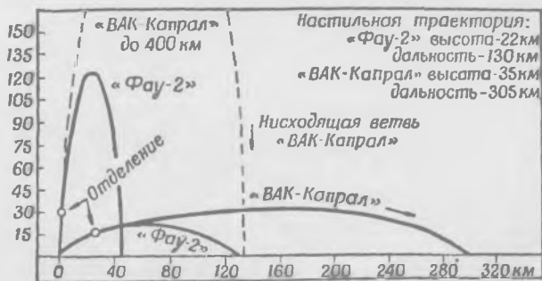
Рис. 50. Типичные траектории полета ракет, запускавшихся по «проекту Бампер»
