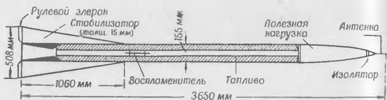
Рис. 54. Ракета ASP (снаряд для исследования атмосферы). Уменьшенный вариант этой ракеты известен под сокращенным наименованием WASP
