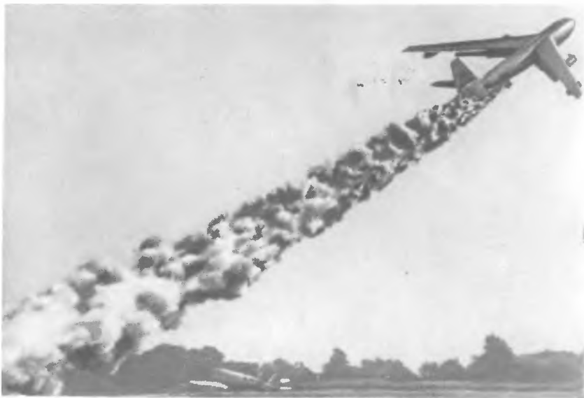
Взлет реактивного бомбардировщика В-47 с помощью стартовых ускорителей на твердом топливе фирмы «Аэроджет»
