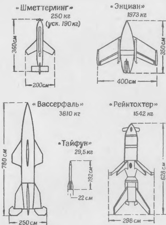
Рис. 42. Немецкие экспериментальные зенитные реактивные снаряды
