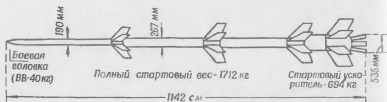
Рис. 39. Ракета «Рейнботе». Первая многоступенчатая ракета (три ступени и стартовый ускоритель), применявшаяся при обстреле Антверпена
