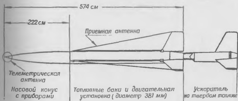
Рис. 48. Схема высотной исследовательской ракеты «Аэроби»
