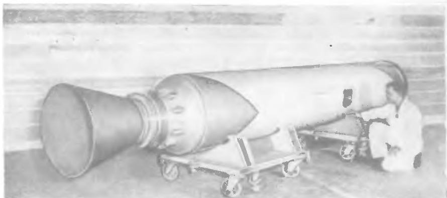
Большой ракетный двигатель «Пушер» на твердом топливе (завод в Макгрегоре, Техас, США)
