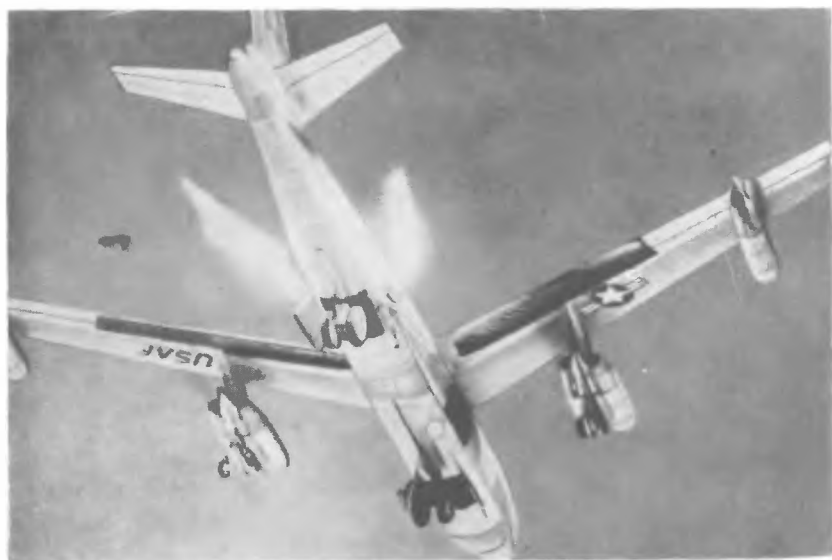
Взлет реактивного бомбардировщика В-47 с помощью системы самолетных жидкостных стартовых ракет YLR45-I фирмы «Аэроджет»
