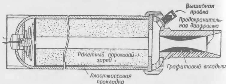
Рис. 33. Ускоритель на твердом топливе
