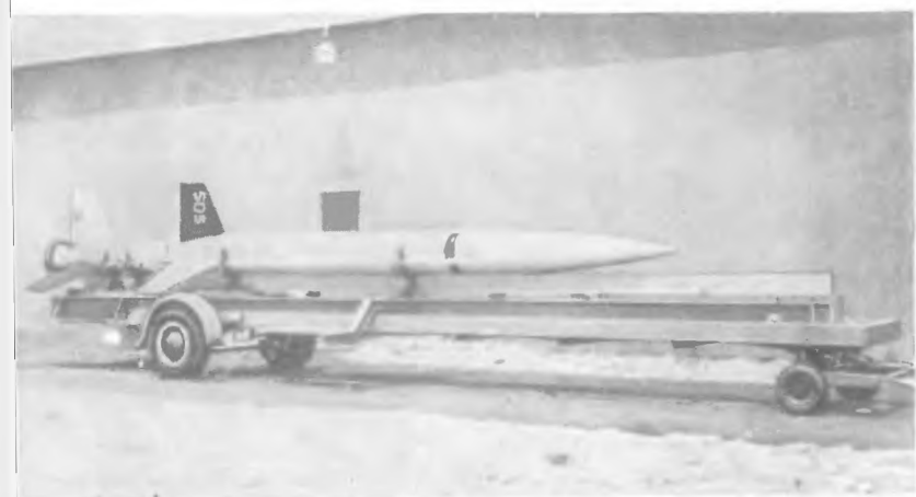
Ракета «Аэроб» со стартовым ускорителем на тележке транспортера
