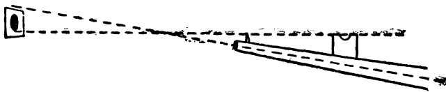
Рис. 73. Обычная схема прицеливания (при стрельбе из винтовки).
