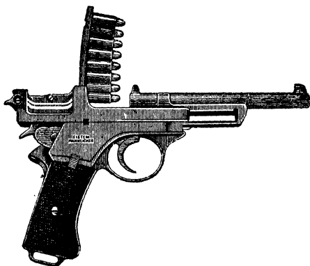
Р и с. 30. Пистолет военного образца сист. Манлихера (Австрия) 1904/1905 гг., кал. 7,65 мм.
