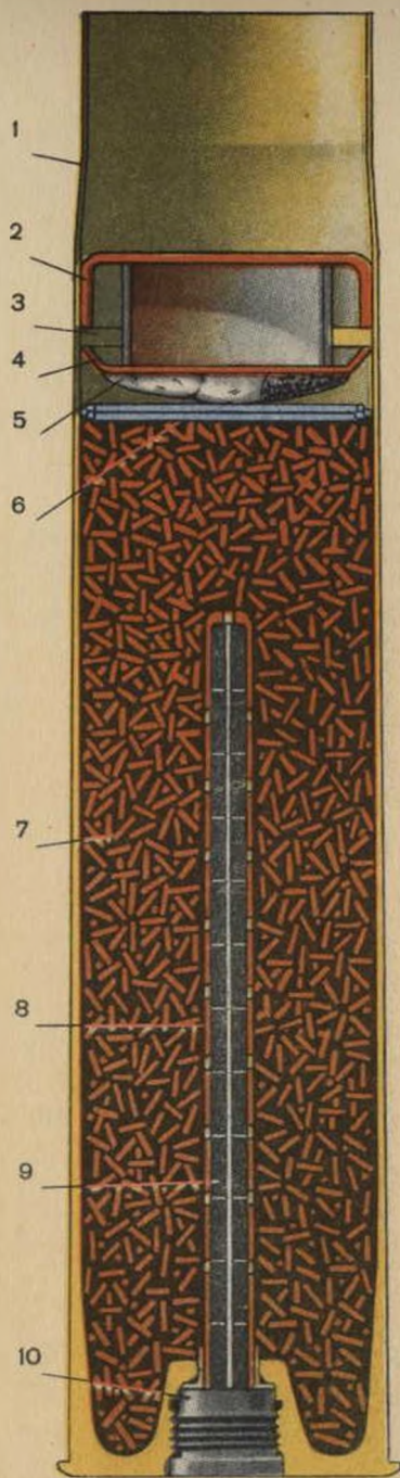
Рис. 117. Боевой беспламенный полный заряд 54-Ж-354 из пороха марки 9/7 к 76-мм дивизионным пушкам:
