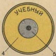
Рис. 143. Учебный патрон к 76-мм полевой пушке обр. 1927 г.: 1 — охлажденный взрыватель; 2 — голова; 3 — учебный заряд; 4 — гильза; 5 — охлажденная массивная штула
