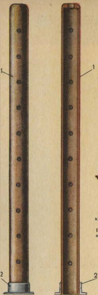
Рис. 134. Центральная бумажная трубка: 1 — корпус трубки; 2 — фланец трубки
