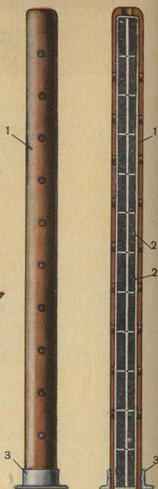
Рис. 136. Снаряженная центральная трубка (пламегаситель):
