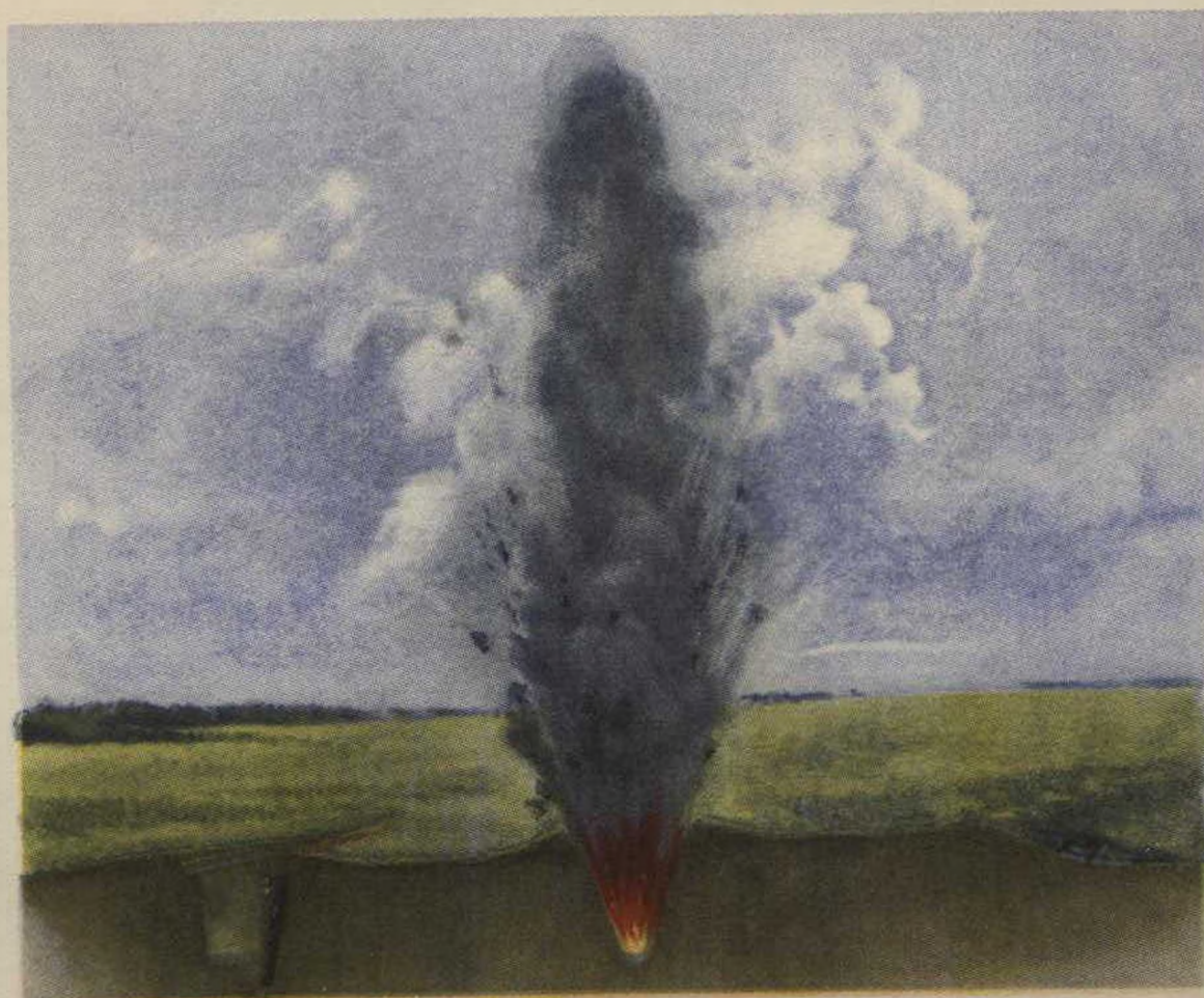
Рис. 163. Разрыв осколочно-фугасной гранаты при установке взрывателя на замедленное действие
