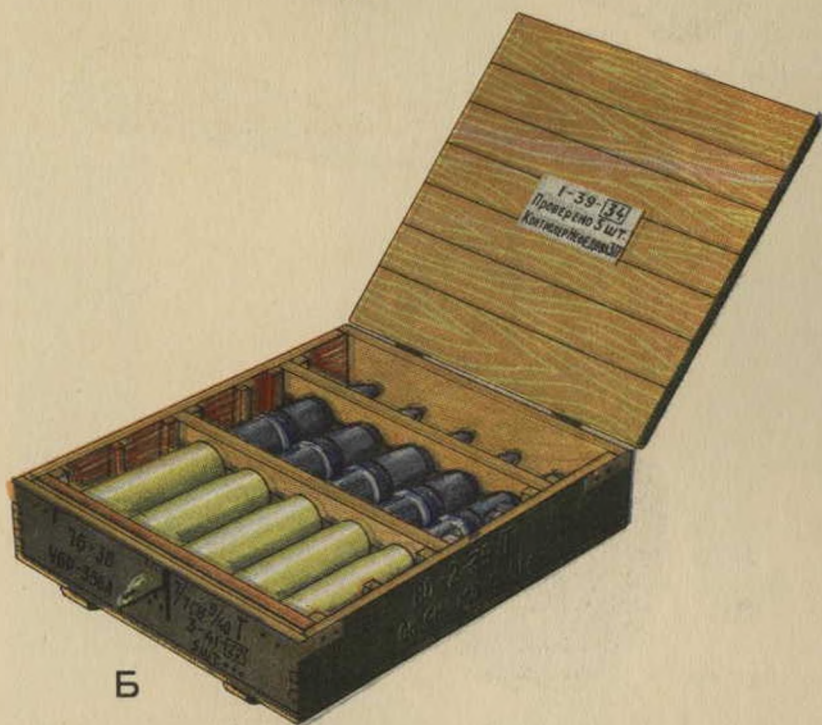
Рис. 148. Ящик с унитарными патронами УБР-356А с бронбойно-трассирующими снарядами: А—общий вид ящика; Б—укладка патронов в ящике
