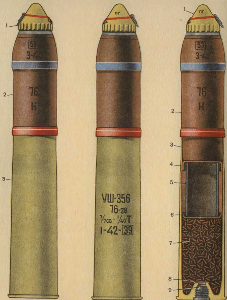
Рис. 32. Унитарный патрон УШ-356 с пулевой шрапнелью, с зарядом из пороха марки 7/7 и 76-мм горной пушаше обр. 1936 г. (в разрезе показано устройство боевого заряда); 1 — 22-сегментная дистанционная трубка; 2 — пулевая шрапнель; 3 — гильза; 4 — obturator; 5 — цилиндр; 6 — кружок; 7 — порох марки 7/7; 8 — иружок; 9 — капсюльная втулка
