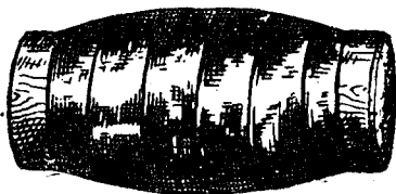
Рис. 3. Деревянный пыж с намотанной и закрепленной на нем лентой из салфеточной ткани
