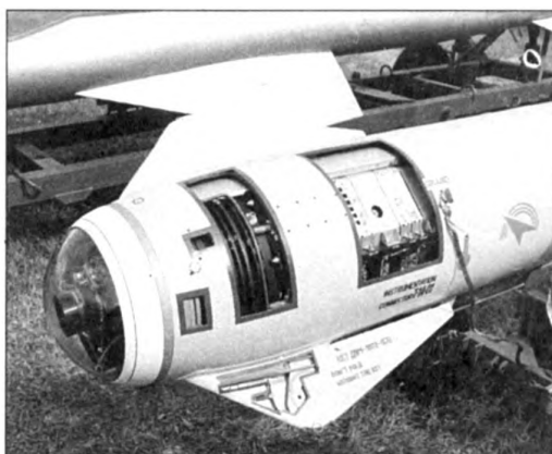
ТГСН «Тубус-2» аппаратуры «Текон-1А» ракеты Х-59МЭ
