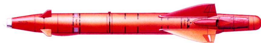
Ракета X-25 опытной партии, предназначенной для испытаний. Яркая окраска служила для облегчения поисков остатков ракет на полигоне
