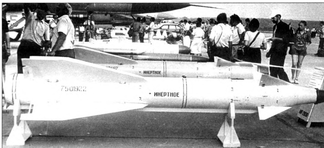
Х-29Л в инертном исполнении без БЧ и порохового заряда двигателя
