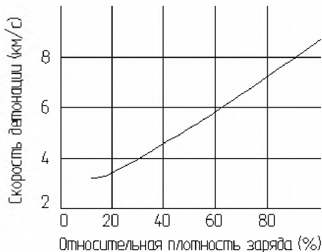
Рис 1. Зависимость скорости детонации от плотности мощных индивидуальных ВВ (ТЭН)
