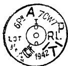
Рис. 38. Выстрел с бронебойно-трассирующим снарядом к шестифунтовой (57-мм) танковой и противотанковой пушкам Mk II и Mk III и полуфутляра к нему № 42
